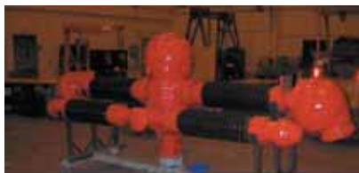
Fig 8 PKV air-blast breaker module
