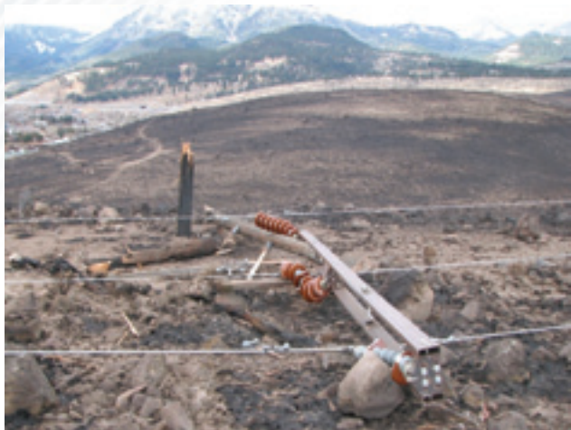
Firestorm damage – ACCC Conductor unharmed
